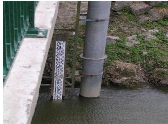
**Photo 2 :** Exemple d'une échelle limnimétrique.
