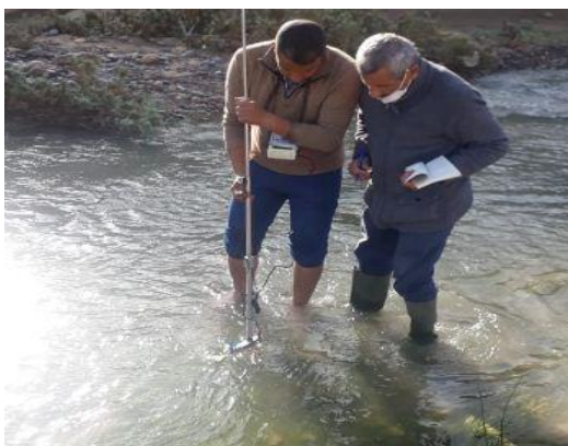
Photo 3 : Mesure des débits de la source (A. BENCHATTOU, 2021)
